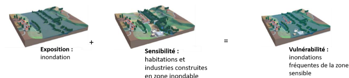
Figure 1 : Notion de vulnérabilité - Source : Les inondations, Ministère de l'écologie et du développement Durable, 2004
