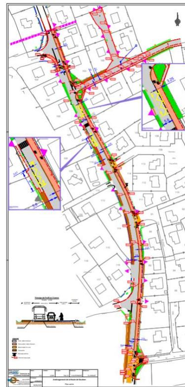
Le projet s'inscrit dans le cadre d'une opération d'entretien de la voirie communale en agglomération intégrant la sécurisation des déplacements actifs sur une distance de 450 mètres d'une part et la construction d'arrêts de cars d'autre part.
