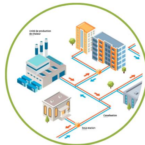
Réseau de chaleur
