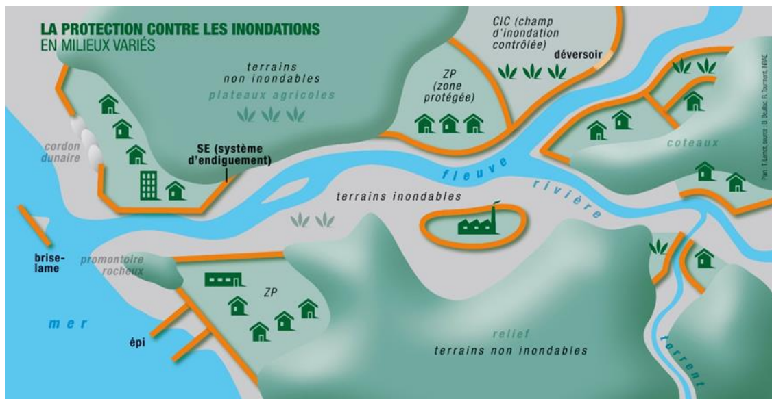
Figure 4 : Notion de système d'endiguement [France Dignes]
