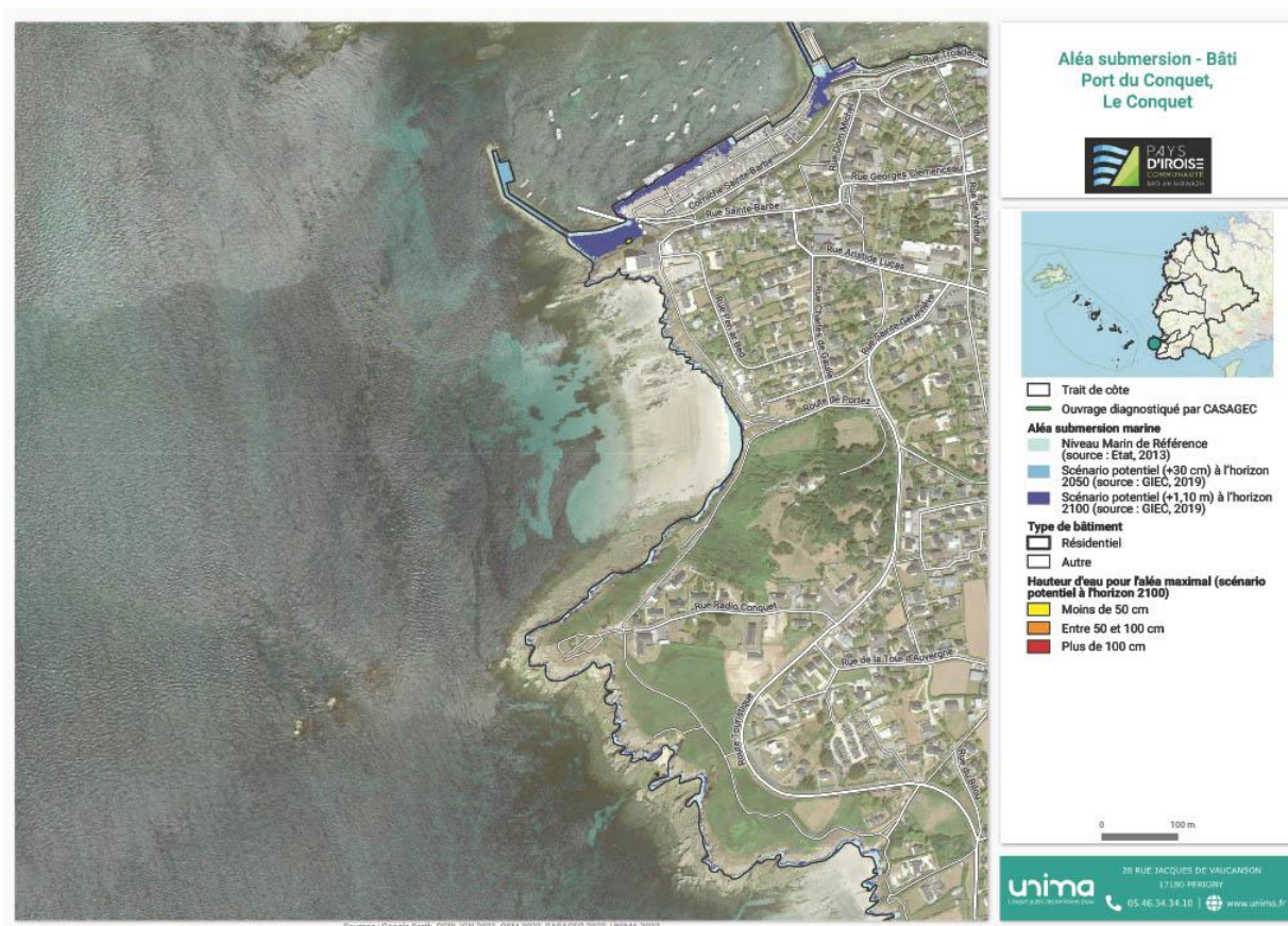
Figure 15 : Enjeux bâtis exposés à la submersion sur le secteur 2 Port du Conquet (Le Conquet)
