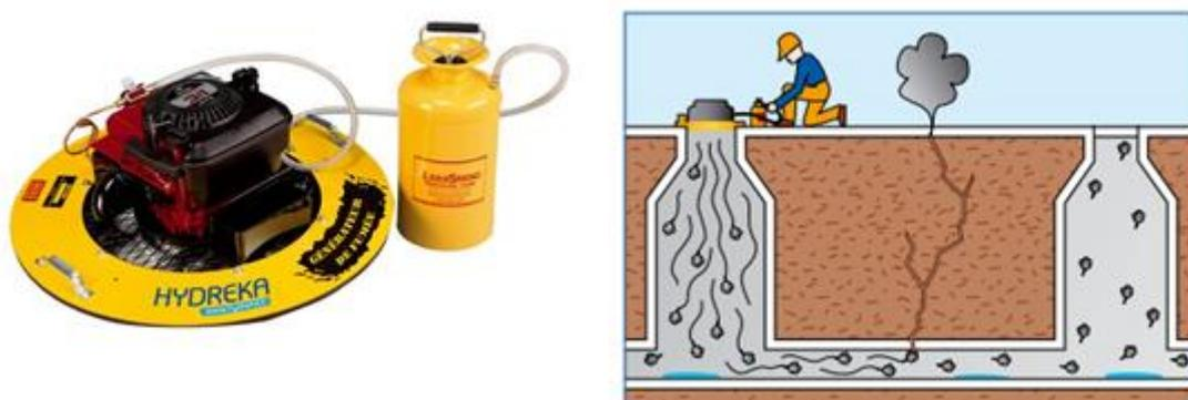
Figure 46. Illustration de la méthode d'un test fumée.
