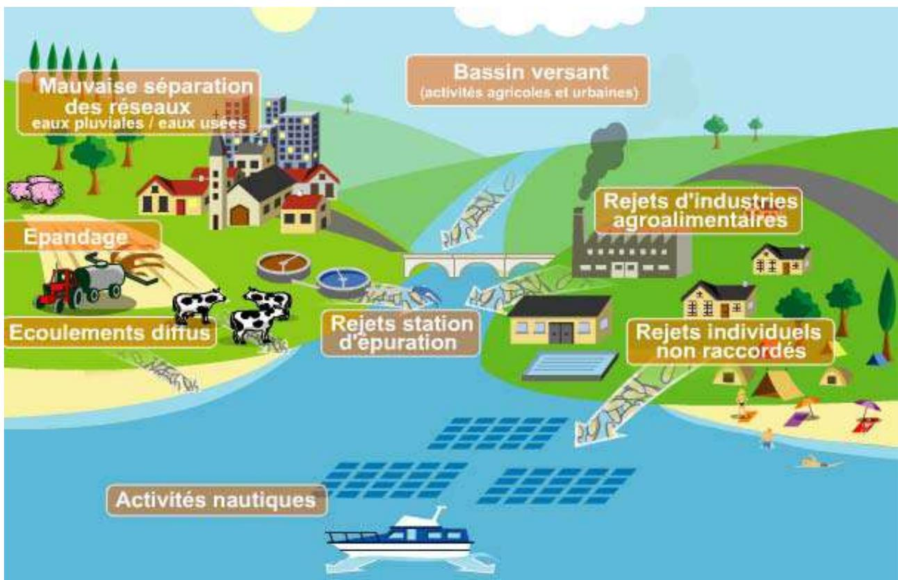
Figure 3 : Origine des sources potentielles de contamination fécale des eaux et des coquillages
